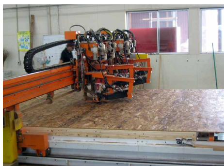
自動釘打ち機で適切な釘打ちが行われていく
