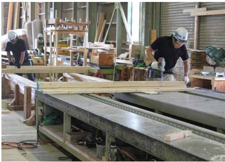
壁パネル（写真左）、床パネル（写真右）とも、現場で施工しやすいパネルに仕上げる
