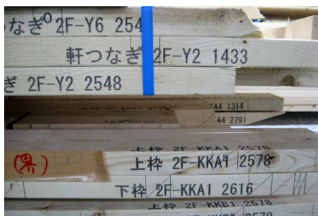
カットと同時に墨付けが行われる
