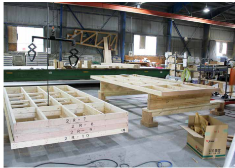
壁パネル（写真左）、床パネル（写真右）とも、現場で施工しやすいパネルに仕上げる
