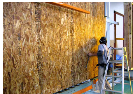
最終チェックでは責任者が目視ですべての釘の状態を丁寧に確認、必要に応じて打ち直す
